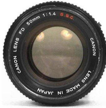
Fig. 9.41. Obiectiv fotografic.FD - indicativul modelului de obiectiv 50 mm - distanța focală 1,4 - deschiderea maximă a diafragmei
