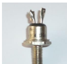
Fig.4.21. Tipuri de capsule pentru tiristoare
